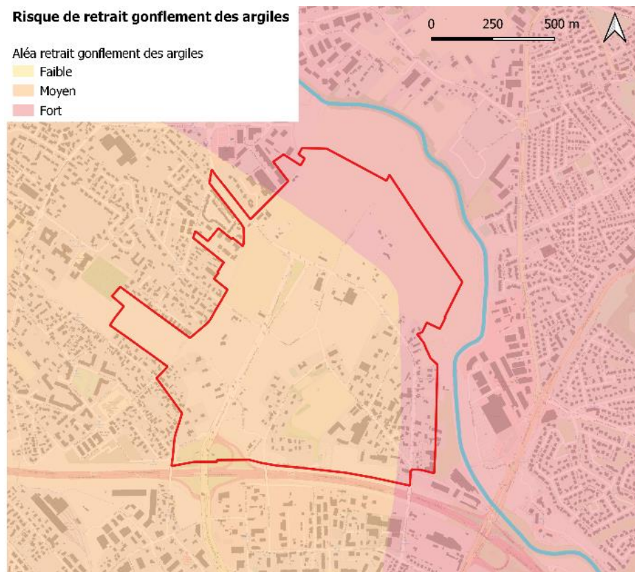
Figure 45: Cartographie des risques de retrait et gonflement des argiles - source : Vizea d'après Géorisques
